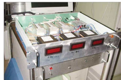
制作した光電子分光装置の電源(静電型分光器への電圧供給)
