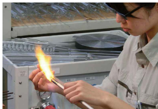
ガラス工作技術専門研修 2015年7月、コパール合金とガラスの接合技術習得するため、実技研修を実施しました。
