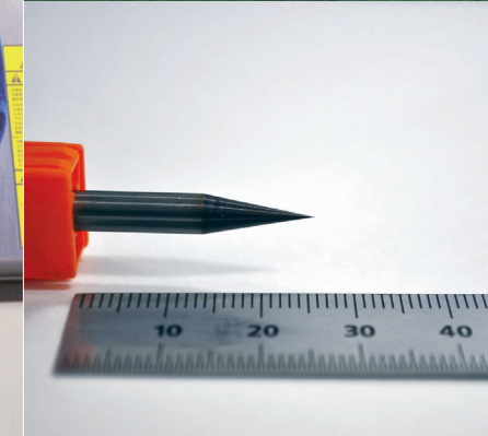
加工で使用したφ0.1mm超硬エンドミル
