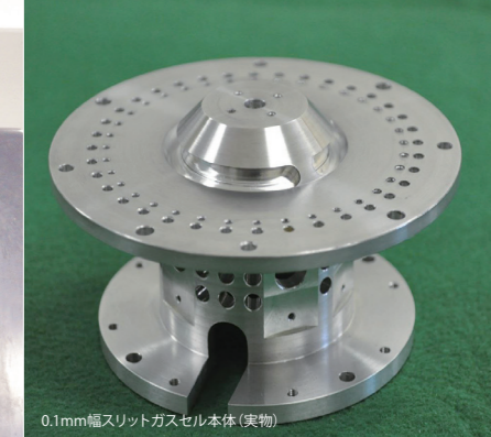
0.1mm幅スリットガスセル本体(実物)
